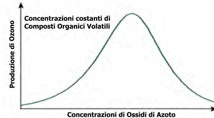
Figura 99: Efficienza nella formazione di ozono a concentrazione costante di Composti Organici Volatili
